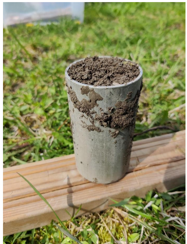
KUVA 1. MAANÄYTE MAAN IRTOTIHEYDEN ANALYSOINTIIN.
