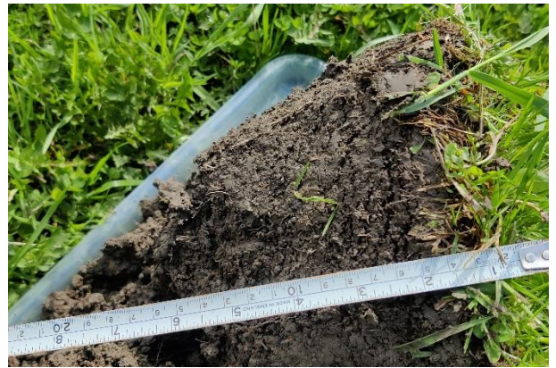
KUVA 2. MAANÄYTE MAAPERÄN ORGAANISEN HIILEN ANALYYSIÄ VARTEN (VASEMMALLA). MAANÄYTE KASTEMATOJEN MÄÄRÄN ARVIOIMISEKSI (OIKEALLA).
